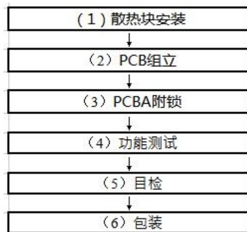
图 3-8 车载无线充电器（WICONN）组装工艺流程图
