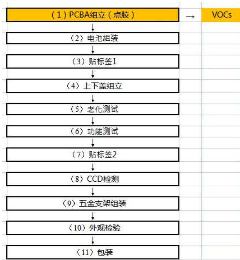
图 3-9 车载无线终端（TBOX）组装工艺流程图
