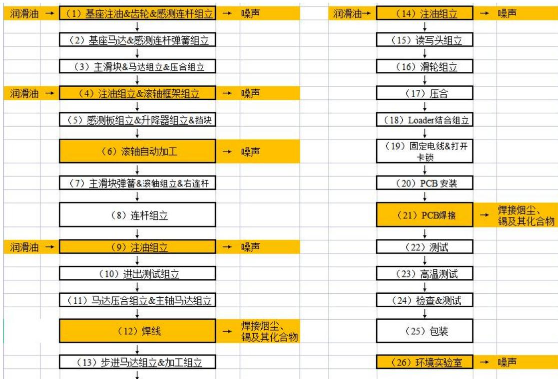
图 3-5 光驱组装工艺流程图
