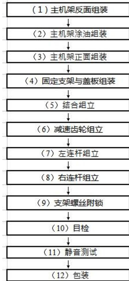
图 3-7 抬头显示器（HUD-K41）组装工艺流程图
